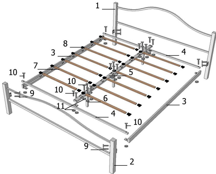
При установке кровати на неровный пол, в конструкции предусмотрена система регулировки ножек по высоте.
