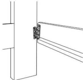
Для складання деталей використовується замкове з'єднання. Потрібно вставити одну деталь в іншу, та з силою натиснути на торець вниз до упору і деталі зібрані.
