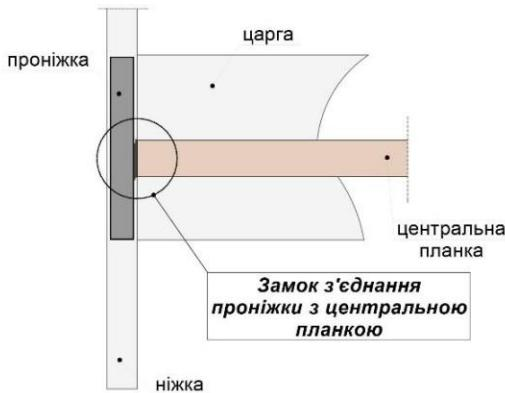
Встановіть центральну планку на з'єднання, які знаходяться на поперечних елементах, та натисніть на планку, щоб деталі стягнулись між собою.
